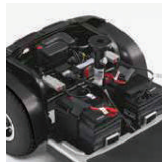
Ugrađena zaštita od prskanja Zaštita elektronike i mjenjača od prljavštine i vode.
